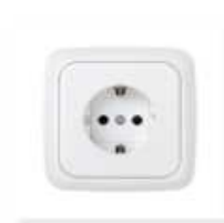
Base de enchufe schuko 16 A 250V~ con dispositivo seguridad y embornamiento a tornillo blanco Simon 31
